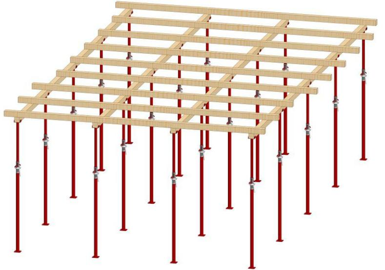
Döşeme ızgaralarının taşıyıcı kirişlerini tutan U başlıklı iç borular dış boru içerisinde 360 derece rahatça dönebildiği için bu sistem ızgara yönlerinin istenilen doğrultuda ayarlanabilmesine ve aynı döşeme kalıbı altında farklı yönlerde bölgesel ızgara yönleri oluşturulmasına imkân sağlamaktadır.
