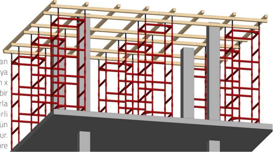
Kovanlı iskele kulelerinin hem altında hem de üstünde bulunan yüksekliği ayarlanabilen ayar elemanları sayesinde hassas yükseklik ayarlarının yapılması mümkündür. Pürüzsüz yüzeye sahip kalıp elemanları sayesinde yüksek kalitede beton yüzeyleri elde edilmektedir.
